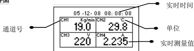
概貌显示界面主要概括显示仪表所有通道的测量值。按  $\rightarrow$  切换到下一个界面，通过  $\uparrow$  或  $\downarrow$  可修改通道号。
